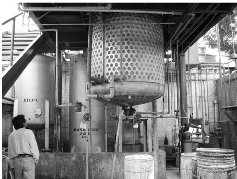
**Foto Núm. 5.** Reactor en donde se producía el látex. Los tambores eran utilizados para el traslado del producto al área de impregnación. Al fondo se aprecian los tanques de día para xilol y monómero de estireno.
