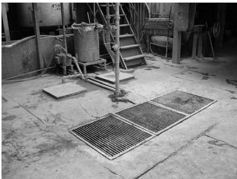
**Foto Núm. 6.** Vista del patio donde se realizaba la preparación de activador. El proceso se realizaba al aire libre. Se aprecia también una rejilla para recuperar los derrames de producto.
