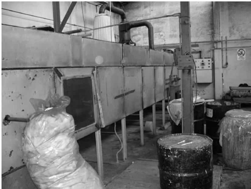
Foto Núm. 8. Vista del horno horizontal para el secado de tela impregnada de polímero.
