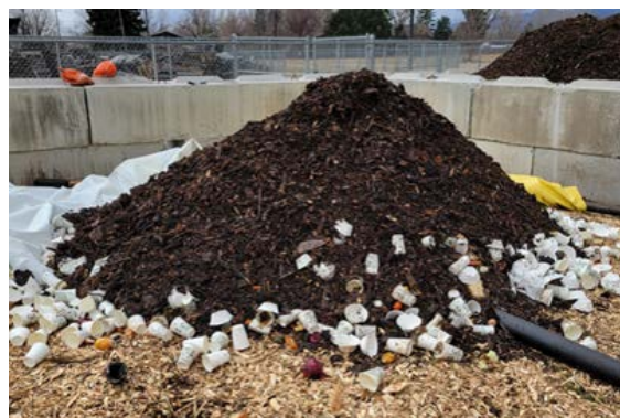
Gráfica 3.9: Ejemplo de acumulación de materiales de envasado compostables en la parte externa de la pila HD de la instalación 1
