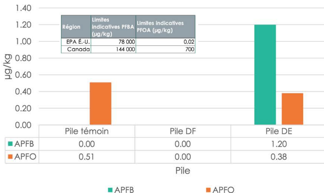
Figure 3.2 – SPFA détectées dans les piles témoin, DF et DE de l'installation 2, et limites indicatives
