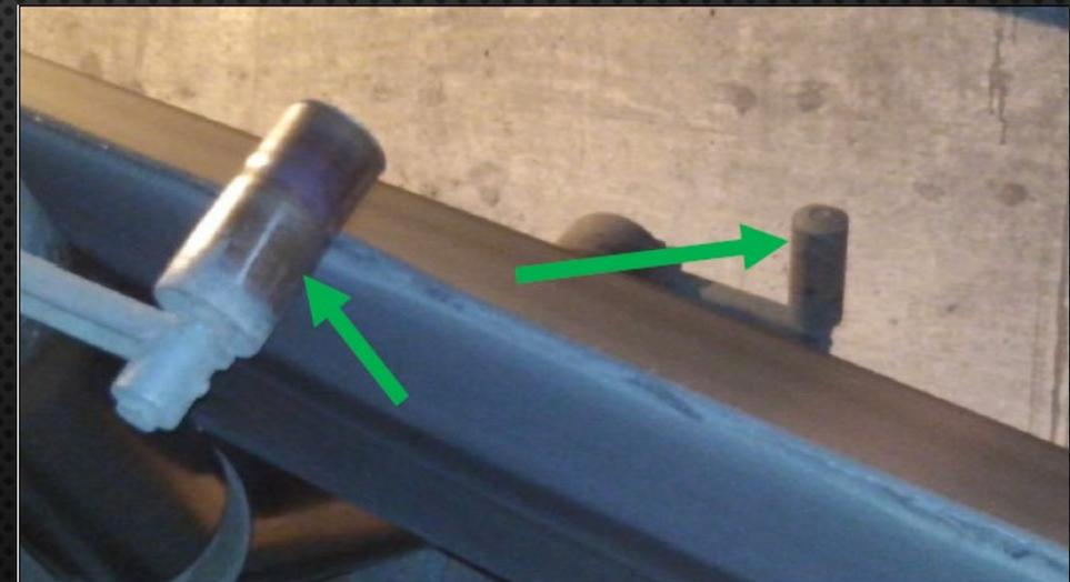
Paros de emergencia en bandas, sensores de alineamiento en bandas. Ambos evitan caída de material y dispersión de partículas.
