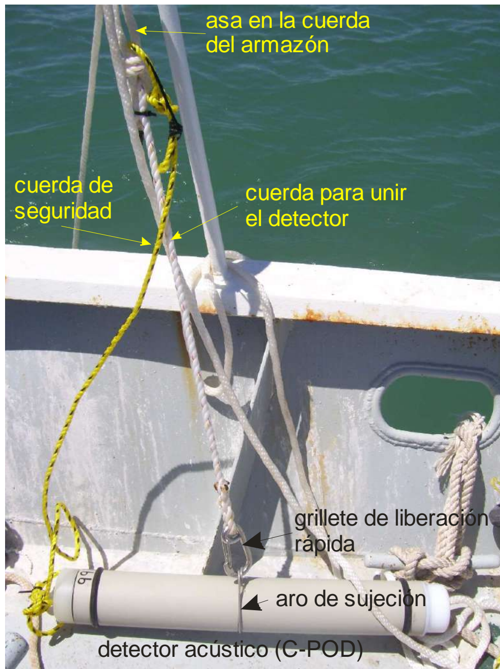
Figura 10. Fotografía de un detector acústico atado a la línea vertical del diseño de anclaje a boyas.
