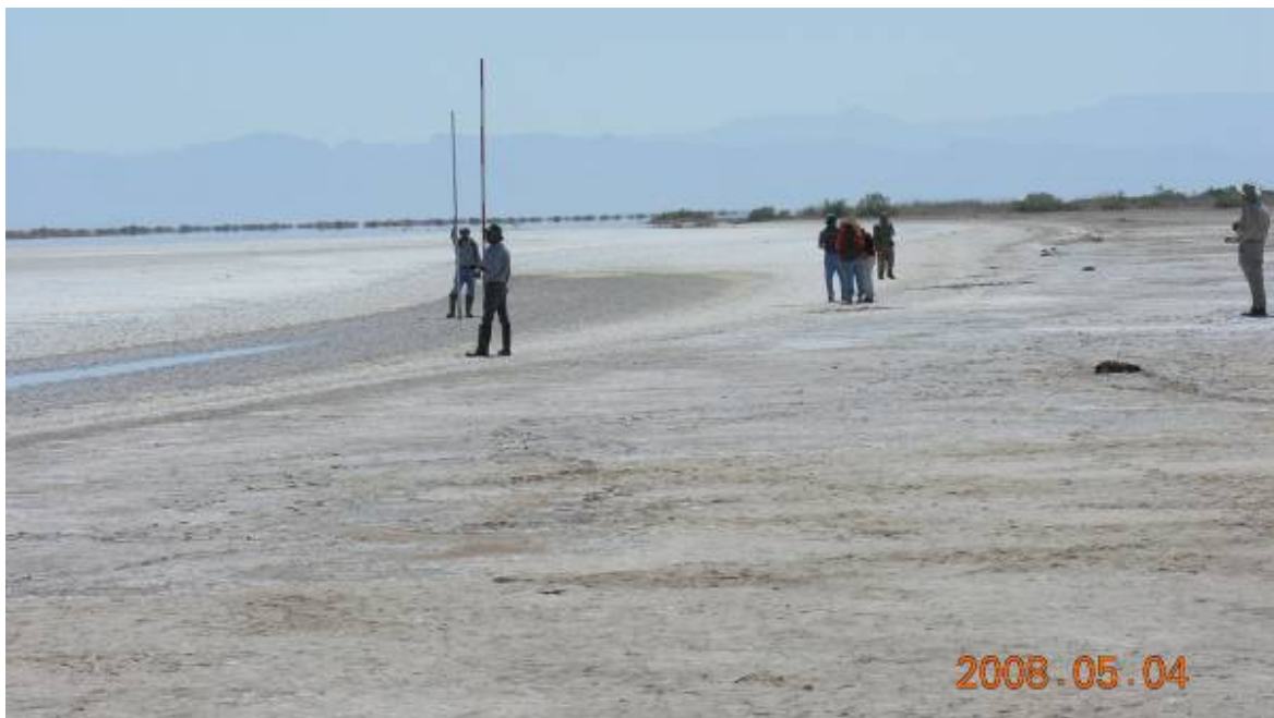
Figura 9. Levantamiento topográfico de una porción de 3km a lo largo del Río Colorado en la parte estuarina, durante marea baja. La porción húmeda del canal del río muestra la influencia de la marea alta anterior. La parte del río en la parte superior de la imagen muestra que durante la marea del día anterior no alcanzó a subir.
