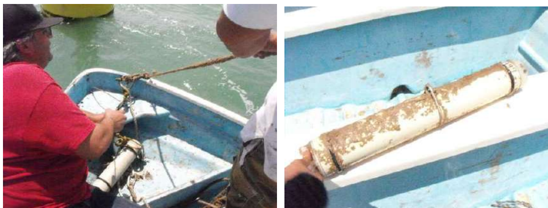
Figura 14. Fotografías que muestran el estado de los detectores y las cuerdas del anclaje a boyas después del período de prueba. A la izquierda se puede apreciar una porción de la cuerda vertical y de la cuerda de amarre del detector. Estas presentaron moderado crecimiento algal. Los amarres principal y de seguridad se hallaban completos y en buen estado. El amarre que forma el asa en la cuerda vertical no mostraba señales de deslizamiento. A la derecha se muestra uno de los detectores usados en la prueba (el que trabajó a 10 m de profundidad), el cual mostró crecimiento algal moderado, de textura suave y fácil desprendimiento.
