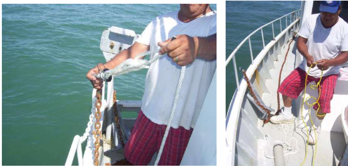
Figura 12. Forma en que se une el extremo de la línea vertical a la cadena del ancla en el prototipo de anclaje a boyas. Por seguridad se hizo un nudo con tres vueltas (fotografía a la izquierda). El ancla utilizada es de tipo arenero de 10 Kg (fotografía a la derecha).
