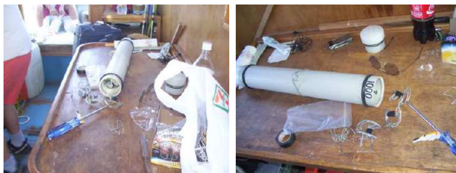
Figura 30. Fotografías que muestran el momento en que se estaba preparando el C-POD número 1000. A la izquierda se ve el detector sin su tapa y se aprecian las baterías y el módulo electrónico. La tapa está en el lado opuesto al módulo del hidrófono. Se observa el aro de acero alrededor de la parte media del detector, que sirve para amarrarlo a los anclajes.
