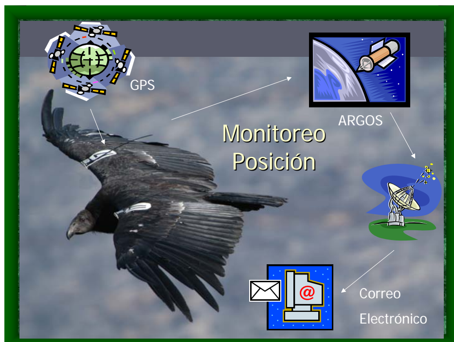
Figura 4. Terminales transmisoras de plataforma (GPS), y segmentos espacial y terrestre del sistema de transmisión satelital
