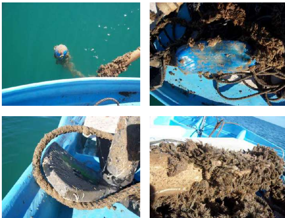
Figura 24. Estado de uno de los anclajes sumergidos después de varios días de trabajo. El denso crecimiento de flora y fauna fue evidente desde que los equipos salieron a la superficie (arriba a la izquierda). La boya perdió presión de aire y las cuerdas cercanas presentaban una densa capa de moluscos bivalvos parecidos a mejillones (arriba a la derecha). El ancla de río, aún enterrada en el sedimento, presentó estructura de carbonato de calcio pegadas a su superficie, resultado de actividad biológica (abajo a la izquierda). El cuerpo del “detector ficticio” fue altamente infestado por los moluscos, aunque estos no llegaron a crecer hacia el lado del hidrófono, aunque esto pudiera ocurrir con más tiempo de trabajo (abajo a la derecha).
