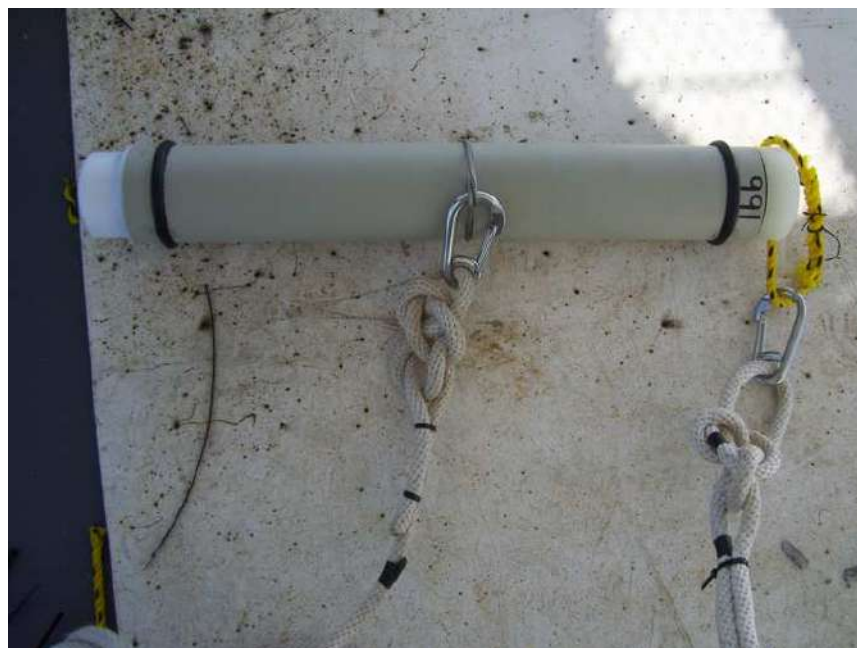
Figura 44. Fotografía de un detector acústico unido a las curdas de amarre y línea de seguridad por medio de ganchos de soltado rápido. Se observa como se colocó un asa de cuerda a la tapa del detector como medio para asir el gancho.
