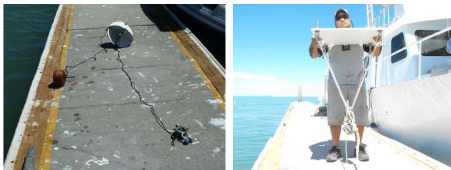
Figura 28. Reflectores de sonar que se instalarán en los anclajes sumergidos para mejorar los procedimientos y tiempos de localización. A la izquierda se muestra un reflector tipo estrella, con cuerdas para su sujeción al anclaje por medio de grilletes, y a una boya rígida para mantenerlo a flote.
