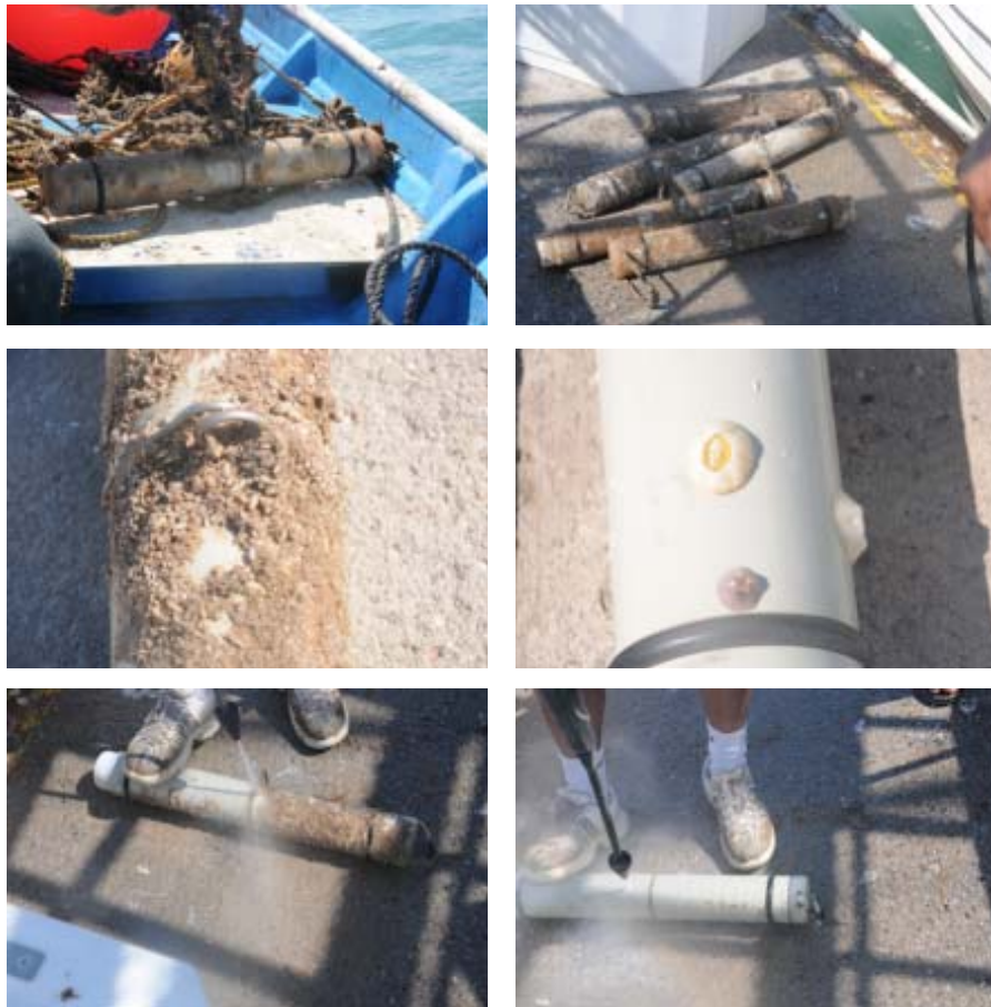
Figura 3. Estado de los detectores acústicos al ser recuperados. Se aprecia como todo el cuerpo del detector estaba cubierto por flora (algas), fauna (diversos invertebrados) y un sedimento lodoso. Incluso, las cuerdas y boya asociadas se hallaban infestadas de moluscos bivalvos parecidos a mejillones. La limpieza se realizó fácilmente con una pistola hidráulica. Después de esta limpieza fueron apreciables conchas de balanos, las cuales sólo pudieron retirarse por medio de una espátula.
