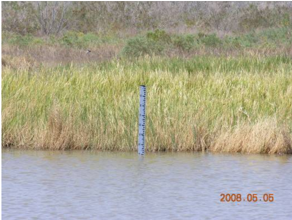
Figura 11. La foto superior muestra la regleta instalada en la parte de influencia de marea, y la foto inferior muestra la regleta instalada aproximadamente 7 kilómetros Río arriba, donde la influencia de la marea no es evidente.
