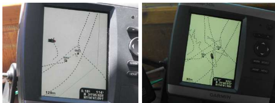
Figura 21. Pantalla del GPS de abordo. A la izquierda se muestran los puntos 0065 y 0067, los cuales marcan la posición de las anclas de río y arenera del anclaje de prueba 1. La posición actual de la embarcación se representa con la figura en forma de barco. En ese momento se estaba realizando la primera aproximación durante la prueba de recuperación. A la derecha se muestran las rutas por las que se había pasado para tratar de enganchar el anclaje.
