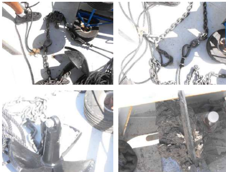
Figura 23. Estado de los elementos del anclaje 2 después de ser recuperado por primera vez. Se aprecia como las cuerdas, guardacabos y grilletes están en buena condición. De igual forma, las anclas muestran rastros del sedimento en que estuvieron enterradas, sobretudo en el ancla arenera (abajo a la derecha). El tipo de sedimento propicia que las anclas se entierren fácilmente, razón por la cual es necesario un elemento mecánico para desprenderlas, tal como el malacate.
