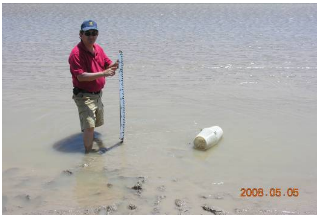
Figura 10. La foto superior muestra al Dr. Jorge Ramírez instalando un sensor automático de nivel del agua. La foto inferior muestra el traspaso de datos a la laptop
