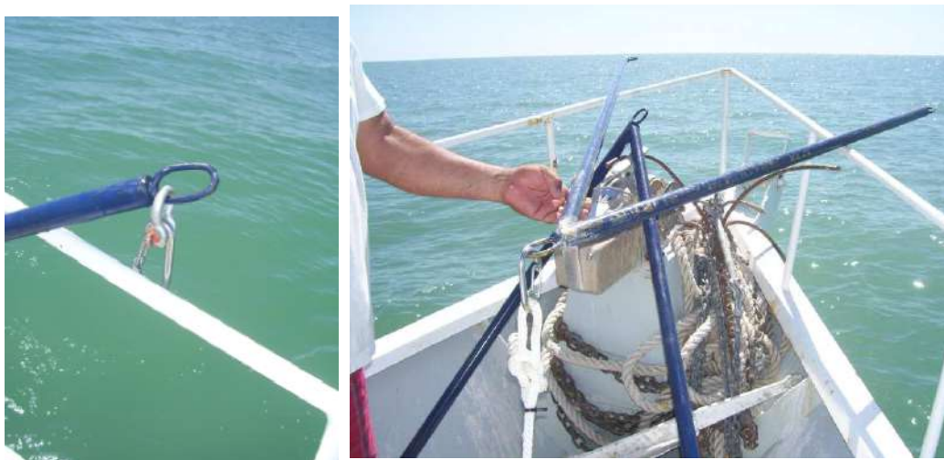
Figura 9. Forma en que se unen los ganchos de soltado rápido a los aros del armazón.
