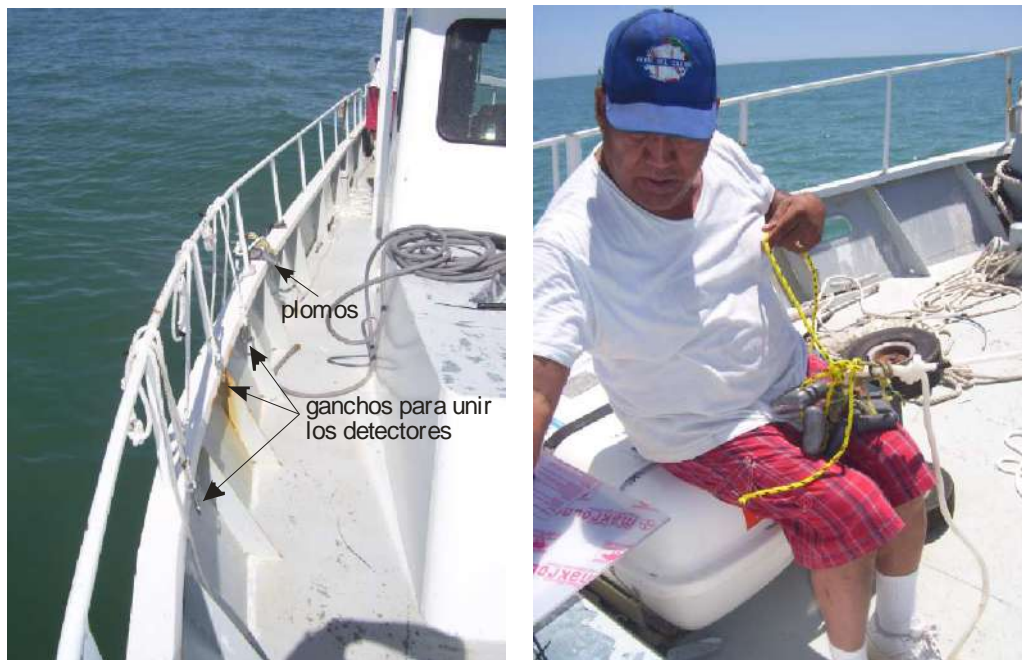
Figura 11. Forma en que se ensamblaron los tres detectores para la prueba de anclaje a boyas. En la fotografía a la derecha se muestra la forma en que se aseguraron los plomos a la línea vertical.
