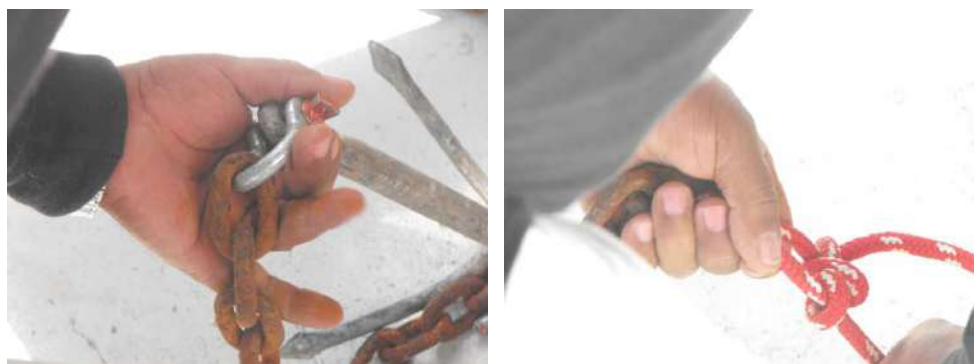
Figura 19. Gancho utilizado para realizar las prueba de recuperación de anclajes sumergidos. A la izquierda se muestra una porción del gancho, donde se aprecian dos de sus puntas las cuales son romas. El gancho tiene un aro a donde se unió una cadena con un grillete. A la derecha se muestra el tipo de cuerda utilizada para jalar el gancho, la cual se une al extremo de la cadena que sostiene al gancho.
