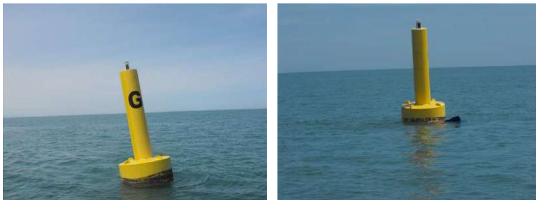
Figura 2. Fotografía de la Boya G, utilizada para el diseño y pruebas experimentales de anclajes a boyas. La fotografía a la derecha muestra a personal haciendo mediciones de la boya y su cadena de sujeción.
