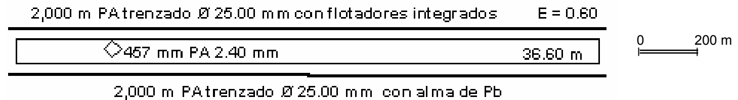
Figura 69. Red de enmalle para tiburón y pelágicos mayores en embarcaciones mayores
