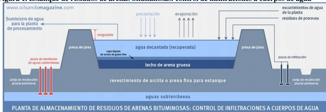
Figura 1. Estanque de residuos de arenas bituminosas: control de infiltraciones a cuerpos de agua
