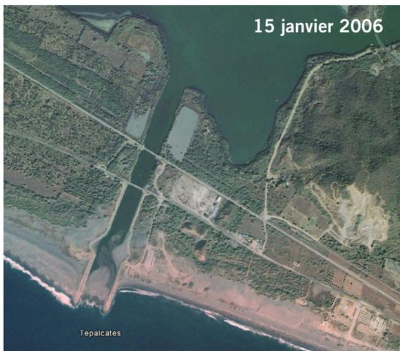
On peut voir clairement un net déplacement de sable vers l'est et une accumulation sableuse dans le secteur de la jetée ouest.
