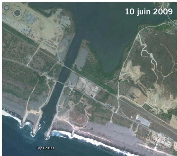
On voit ici le canal dragué, exempt de sable. Les nouvelles jetées s'assortissent d'une ouverture de 500 m et constituent un point de repère pour l'agrandissement et le dragage du canal.
