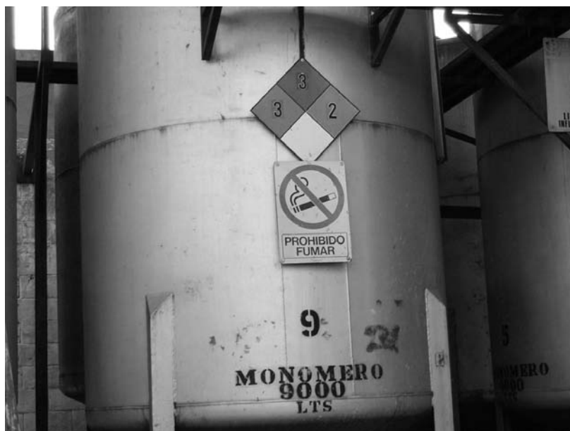
Photo n° 3 : Réservoir d'entreposage de monomère de styrène d'une capacité de 9000 litres. Seuls certains des réservoirs comportaient les avertissements appropriés.
