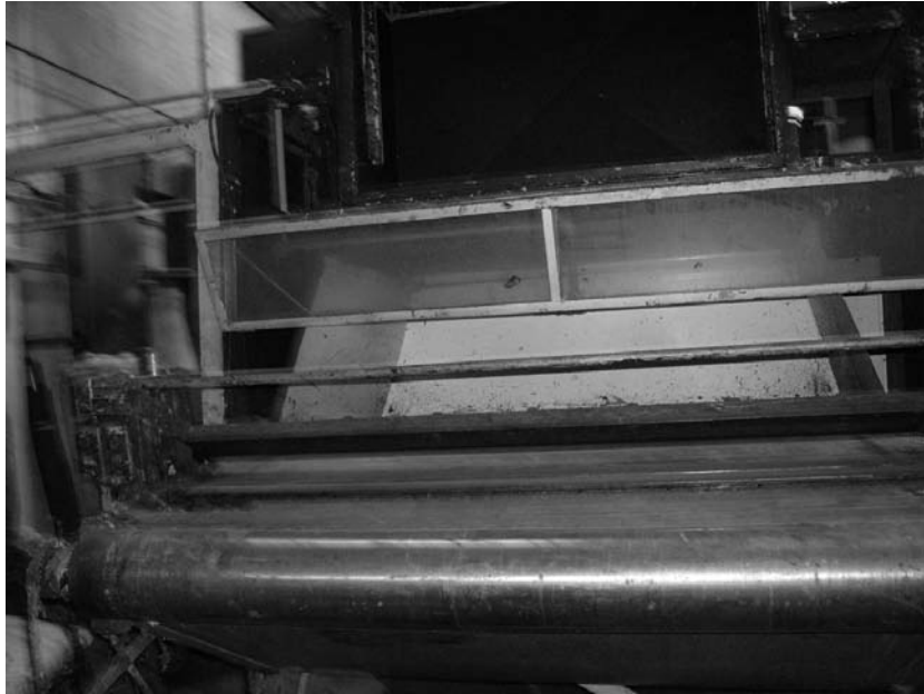
Photo n° 7 : Machine servant à imprégner les toiles de polymère.
