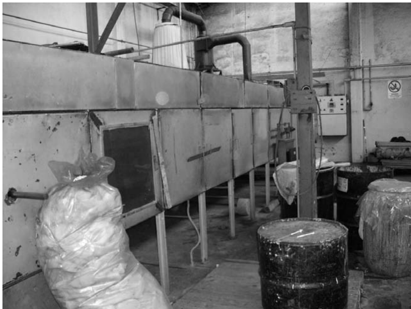
Photo n° 8 : Vue du fourneau horizontal servant à sécher la toile imprégnée de polymère.
