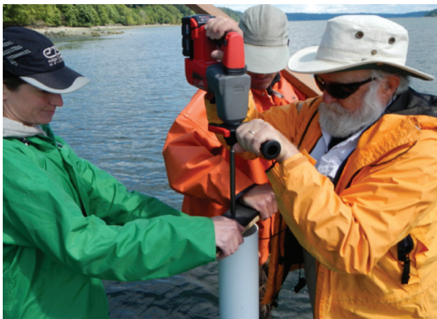
Figure 4. Carottage de sédiments à l'aide d'un marteau perforateur
