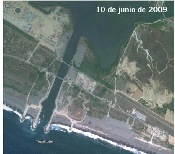
Aquí se muestra el canal dragado y sin arena. Las nuevas escolleras tienen una apertura de 500 m y forman la guía para la ampliación y dragado del canal.
