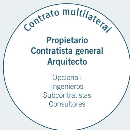
Gráfica 5: Estructura de un contrato de "diseño-construcción"
