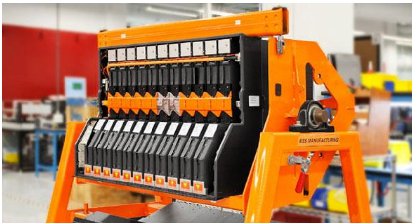
Gráfica 2. Batería de níquel-hidruro metálico (Ni-MH) para vehículos eléctricos híbridos
