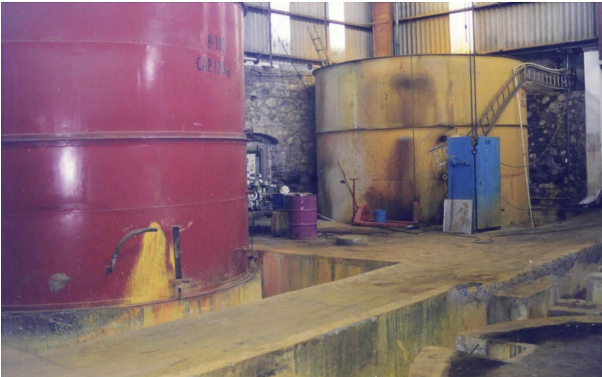
174. Pour la précipitation des pigments jaunes, on utilisait de l'eau chaude comme agent réactif, ce pourquoi il fallait une chaudière, et la précipitation des pigments rouges se faisait avec de l'eau froide, c'est pourquoi l'installation était dotée d'une fabrique de glace<sup>367</sup>.
